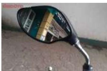
Cermin cembung adalah cermin yang permukaannya cembung dan bersifat divergen (menyebarkan sinar). Pada cermin cembung, bagian mukanya berbentuk seperti kulit bola, tetapi bagian muka cermin cembung melengkung ke luar.
